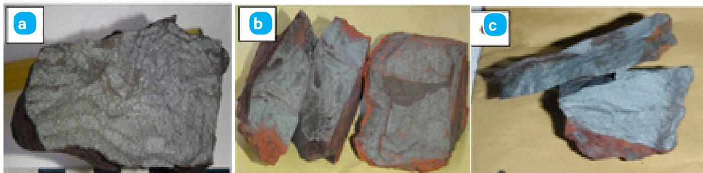
**Figure 3** | Photographie d'échantillons d'hématite massive et laminée des Monts Zatuwa. (3a :Hématite laminée , 3b : Hématite massive , 3c : Hématite massive bleue)
