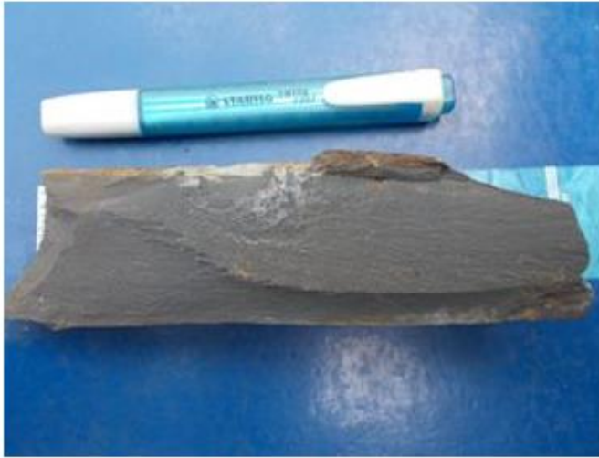
Figure 11 : Shale massif présentant une cassure conchoïdale [Affleurement Kiombilal].
