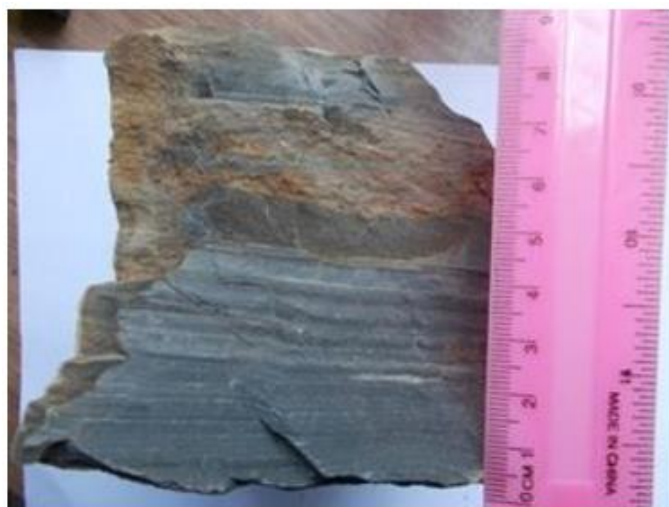
Figure 10 : Lamination parallèle : Ech. MK14 [Source Manzengela]
